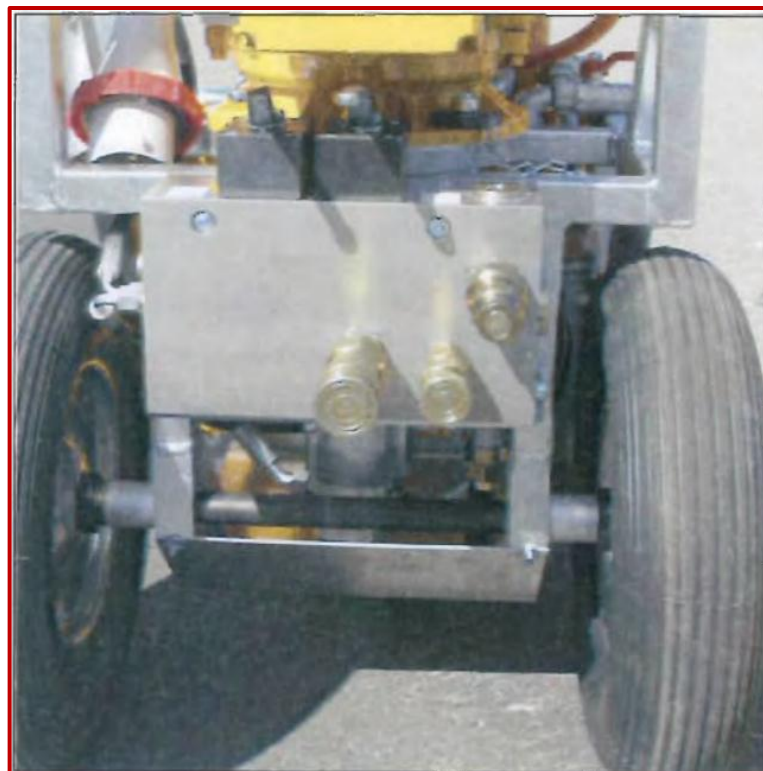
Рис. 9. Разъемы для подключения гидромотора привода каната.
