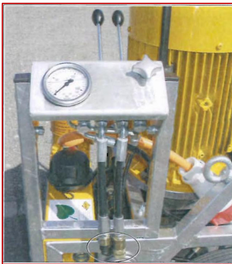
Рис. 8. Разъемы для подключения гидроцилиндра подачи.
