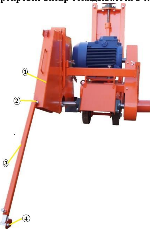
Рис. 7. Устройство визира
