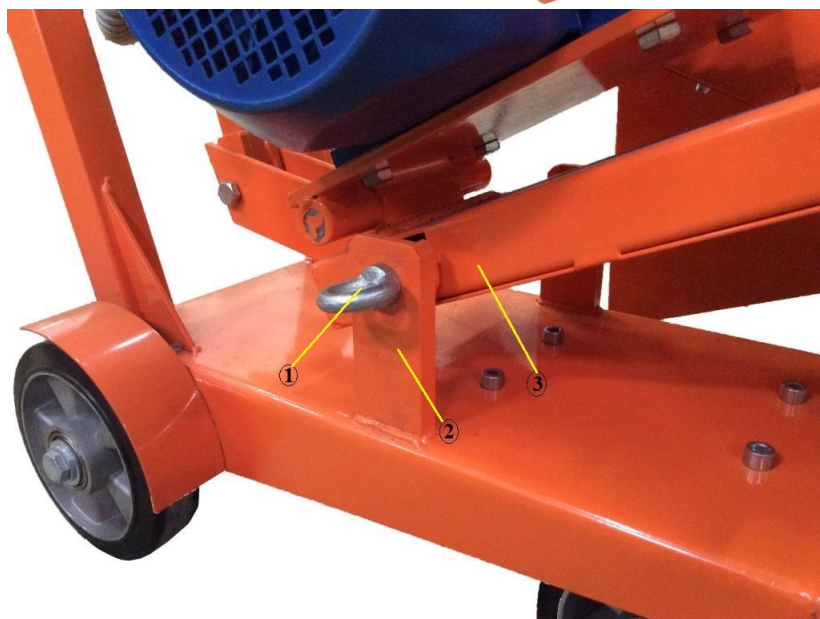
Рис. 4. Порядок установки поворотного стола на тележку
