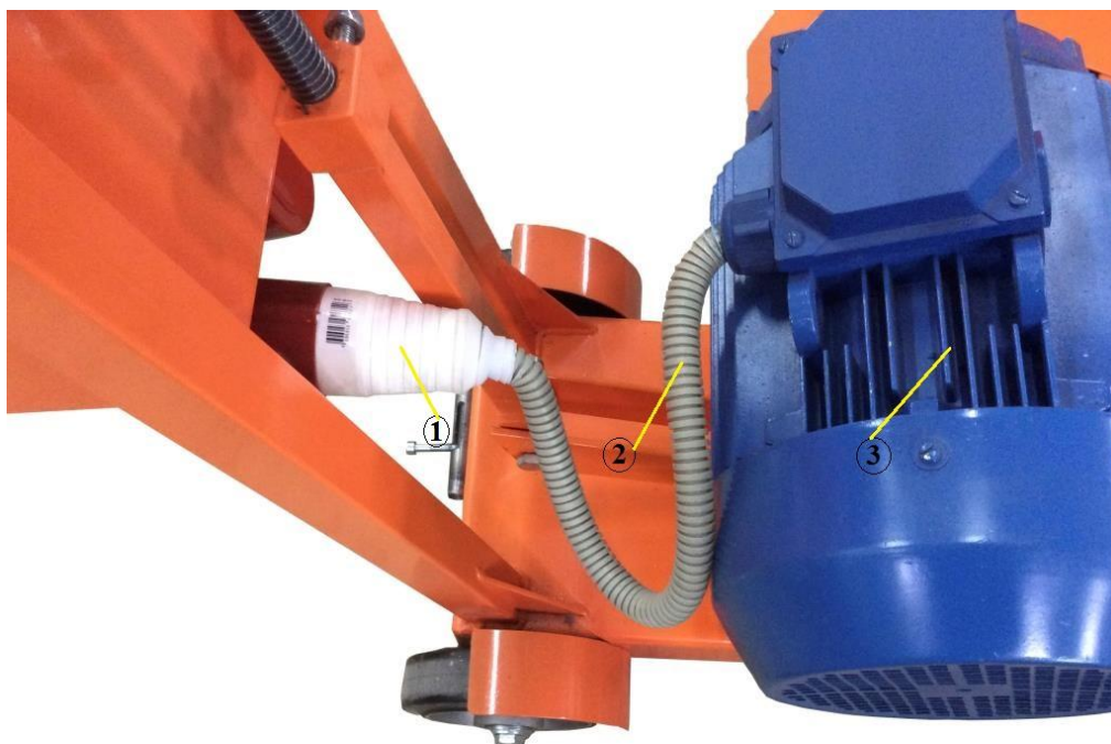
Рис. 5. Подключение электродвигателя
