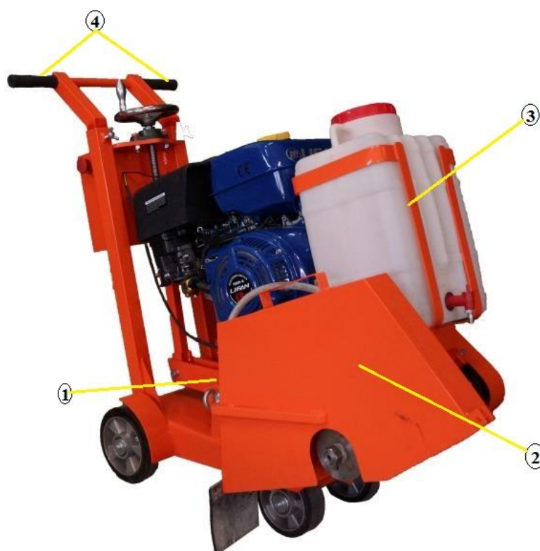
Рис.1. Блоки шварцной машины ДУС ШН-170
