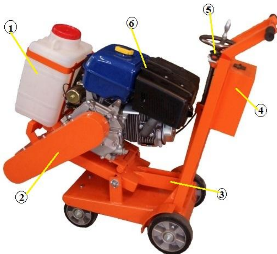
Рис.2. Элементы конструкции шварцовой машины ШН-170
