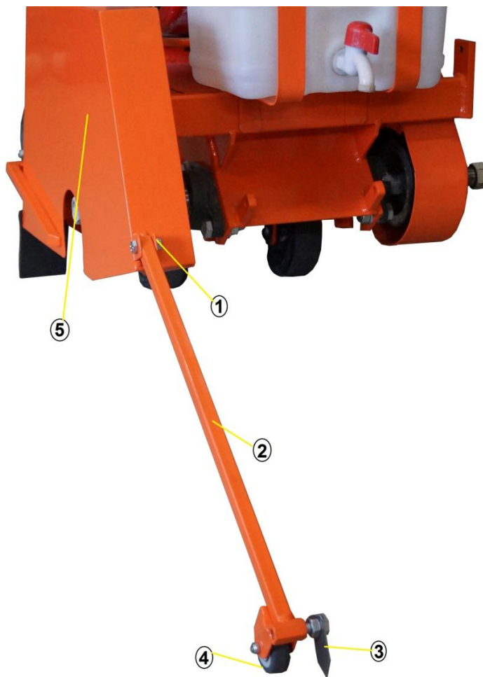
Рис 6. Устройство визира
