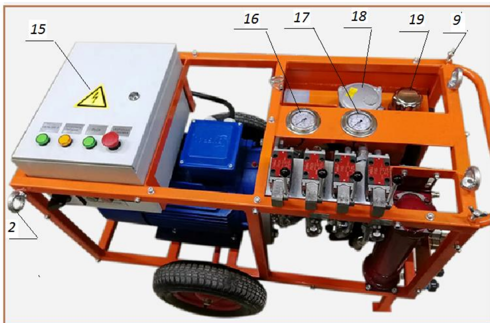
Рис.1.2. Конструкция маслостанции «DUS PP 45-18-M»
