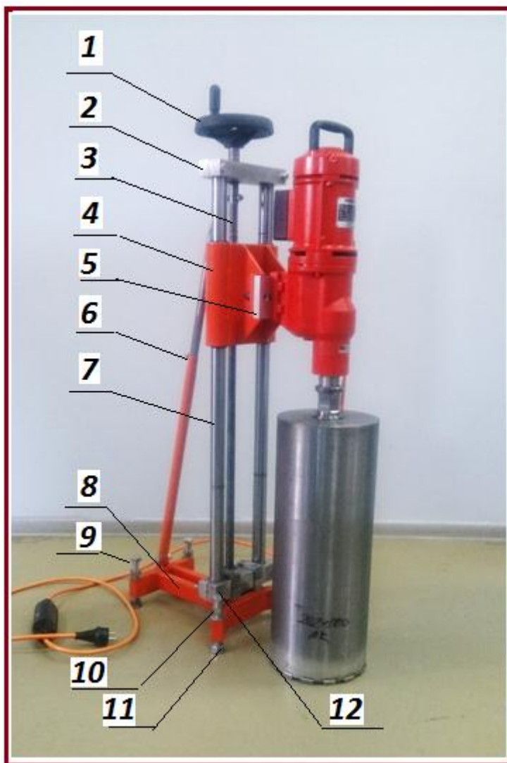
Рис.2.Общий вид штатива DUS DDS-350.
