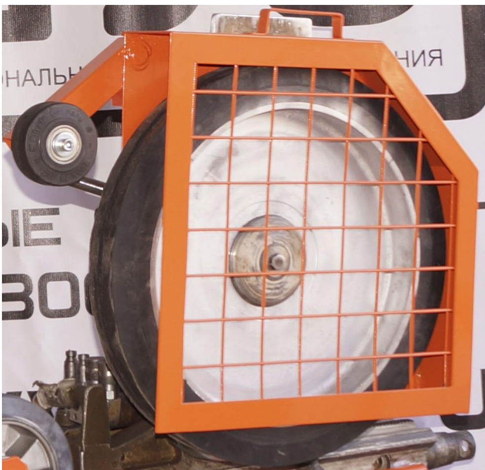
Рис. 4 Кожух приводного колеса.
