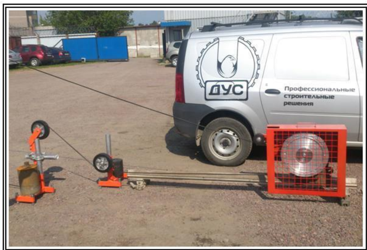
Рис. 4.2. Установка роликовых стоек
