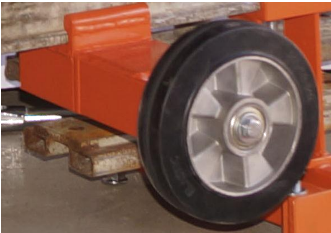
Рис. 3 Передвижной ролик накопителя каната.
